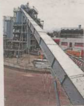
Le combustible alimentant l'usine de cogénération est chargé sur ce tapis roulant.
