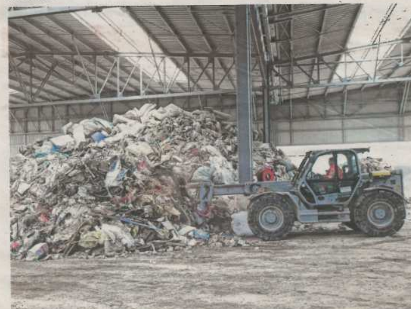
Sur le site de Villers-sous-Montrond a été construit un centre de tri des déchets du bâtiment. Ces derniers seront broyés pour fabriquer des combustibles solides de récupération (CSR) destinés à alimenter l'usine de cogénération.
