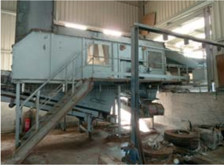
3. Le broyeur secondaire (granulométrie 0/80 mm) qui sépare les lourds (cailloux, verre, bois lourd), est complété par un séparateur aéraulique (à gauche).
