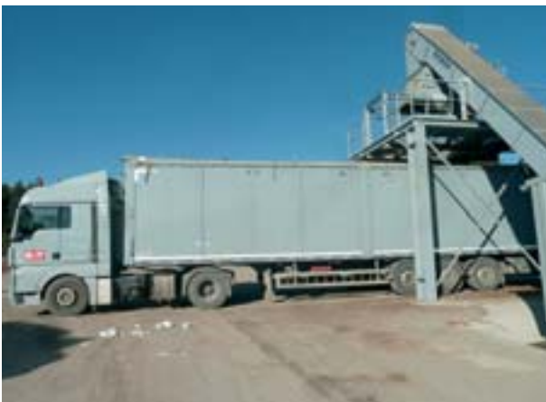
9. À la suite de la vis sans fin, une chaîne à godets remplit les camions à fond mouvant. Celui-ci part demain matin pour la cimenterie de Rochefort-sur-Nenon.
