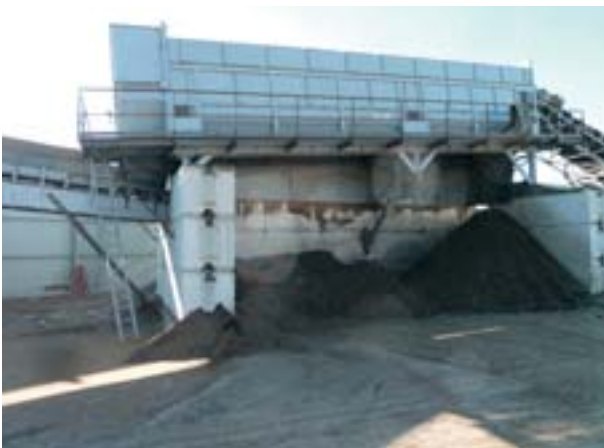
2. Le broyat passe dans un trommel qui retire les fines, et complété par le deuxième overband, plus à gauche.
