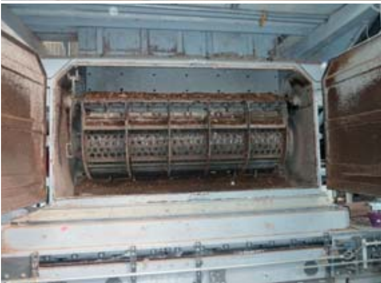
4. Le broyeur tertiaire dispose de grilles à trous ronds.
