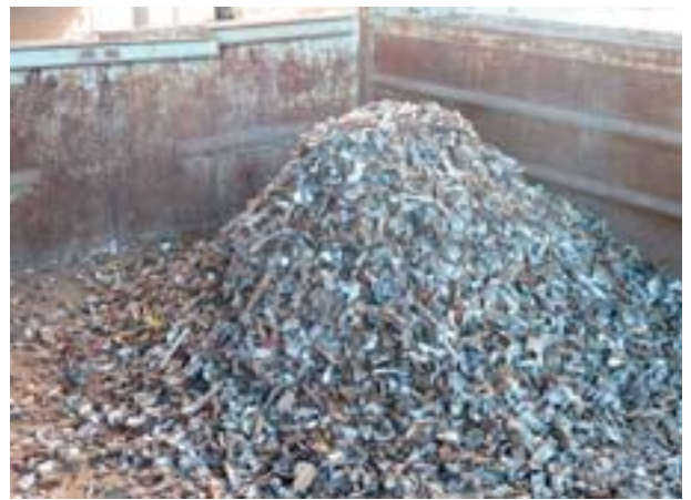
6. Le puissant séparateur à courant de Foucault extrait de nombreux morceaux à base d'aluminium.
