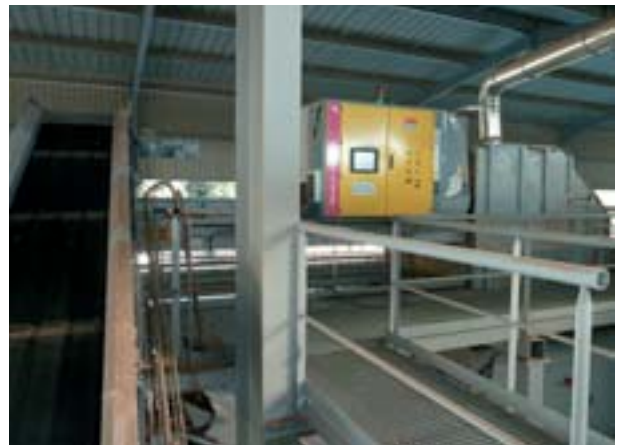
7. Les deux trieuses optiques contribuent à réduire le taux de PVC à un maximum de 0,28 %.
