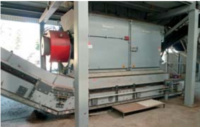
3. Le broyeur secondaire (granulométrie 0/80 mm) qui sépare les lourds (cailloux, verre, bois lourd), est complété par un séparateur aéraulique (à gauche).
